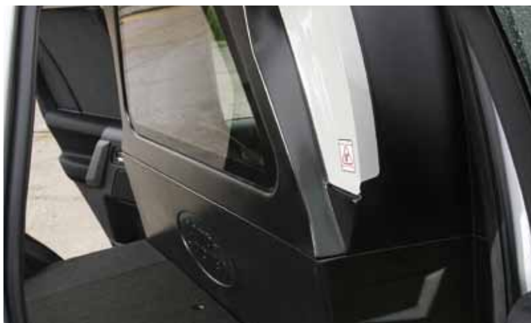
Toegang tot laadruimte via achterportieren en tussenschot gezien vanuit laadruimte.
