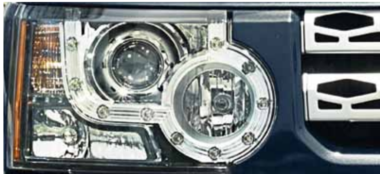
Adaptieve, met stuuruitslag meedraaiende koplampen met bochtverlichting.
